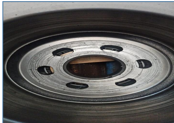
IMAGEM COM DETALHE DO SINO DANIFICADO
