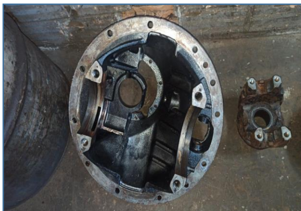
IMAGEM DE PARTE DA CARCAÇA DO CONJUNTO DIFERENCIAL ABERTA, ALOJAMENTO DO ROLAMENTO CENTRAL (“PORQUINHO”) NECESSITA DE REPAROS
