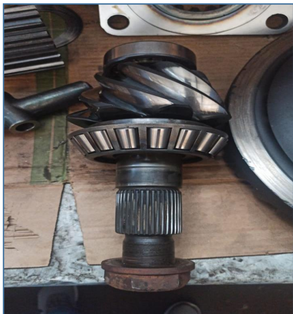
IMAGEM DA COROA E PINHÃO DESMONTADOS – NÃO DANIFICARAM
