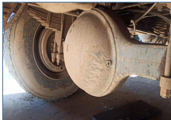
IMAGEM DA CARÇA EMPENADA DO CAMINHÃO BASCULANTE
